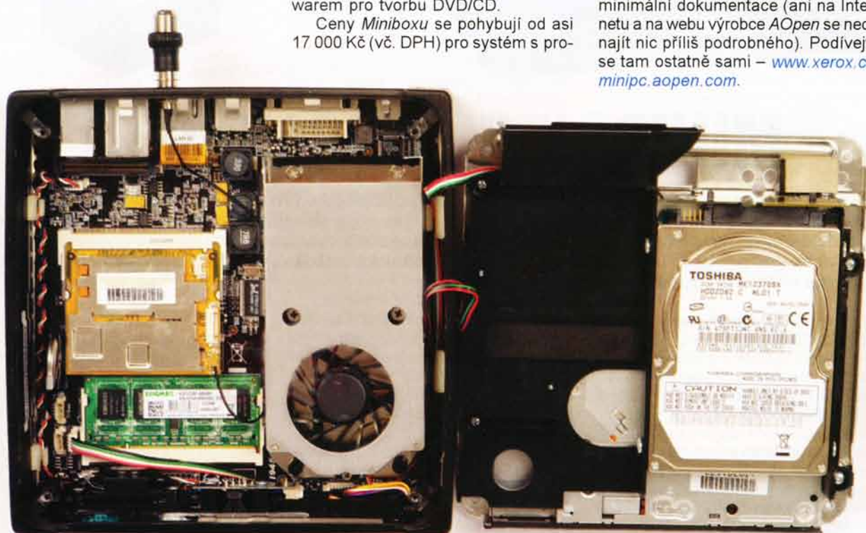
Takhle vypadá Minibox II vevnitř po odklopení horního víka s optickou štěrbínovou mechanikou CD/DVD a pevným diskem
