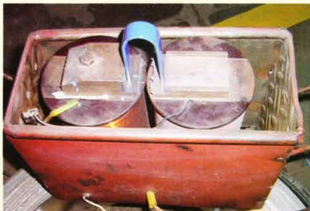
Obr. 5. Dodnes používaná magnetovačka na permanentní magnety pro stavebnici Merkur - elektro
