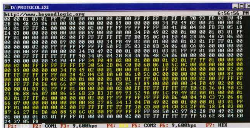
Obr. 4. Protocol Analyser pracující v režimu Hex Mode. Bíle jsou zobrazena odeslaná data, žluté jsou pak zobrazena přijímaná data
